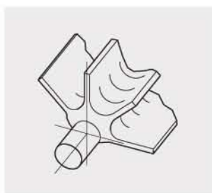
■ Rotori con tasche raccordate Rotors with radiused pockets
